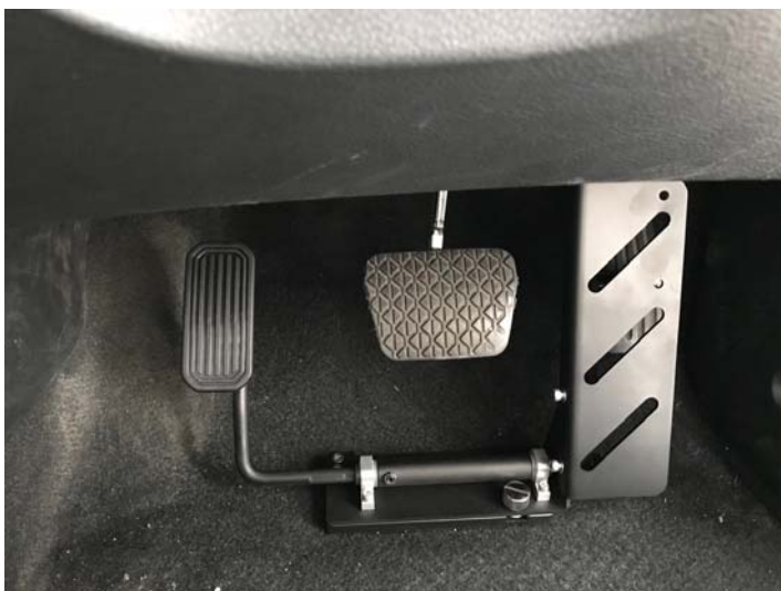
図2 脳卒中後遺症患者の運転リハビリ リテーション支援 (脱着が容易な左足アクセルペ ダルによる習熟)
