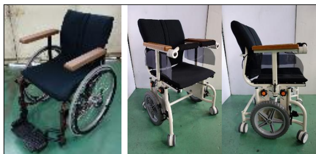
図 7. ムービングチェア（左）とウォーキングチェアの試作機
